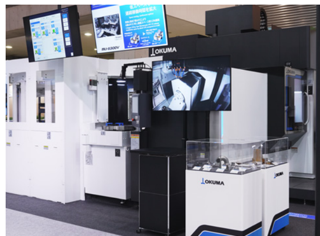
5軸制御立形マシニングセンタ MU-6300V 昇降2段式7面APC
