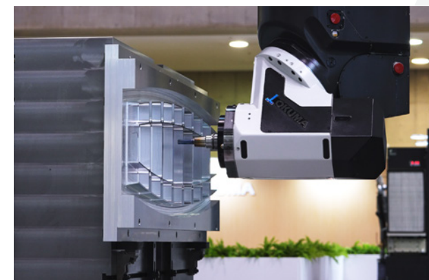
高速高品位5面加工門形マシニングセンタ MCR-S スイベルヘッド仕様
