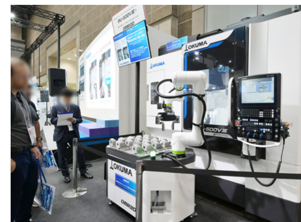
5軸制御立形マシニングセンタ+移動式協働ロボット MU-500VⅢ + OMR20
