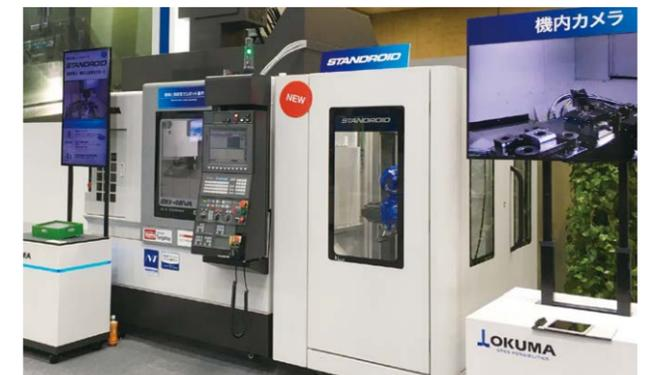
立形マシニングセンタ+STANDROIDの「超簡単ロボットパッケージ」
