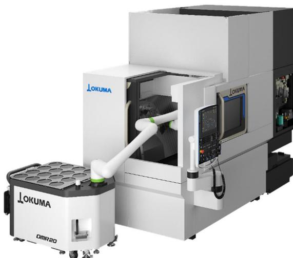
OMR を接続したロボット加工セル
