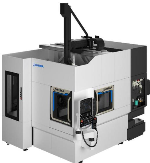
ローダを機上に設置した自動化セル
