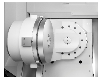
ノンバックラッシュ駆動方式を採用した 高精度・高追従性トラニオンテーブル
